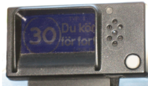
Exempel på hur ett varningssystem i fordonet kan se ut. Detta system varnar också genom ett pipande ljud, om inte hastigheten sänks. Foto: Lena Dafgård.
